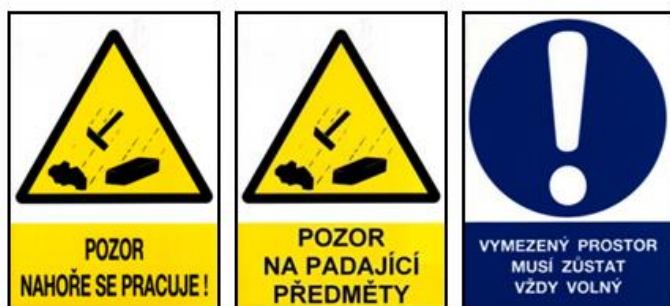
Obr. 4.: Bezpečnostní tabulky vymezující ohrožený prostor pro práce ve výškách
