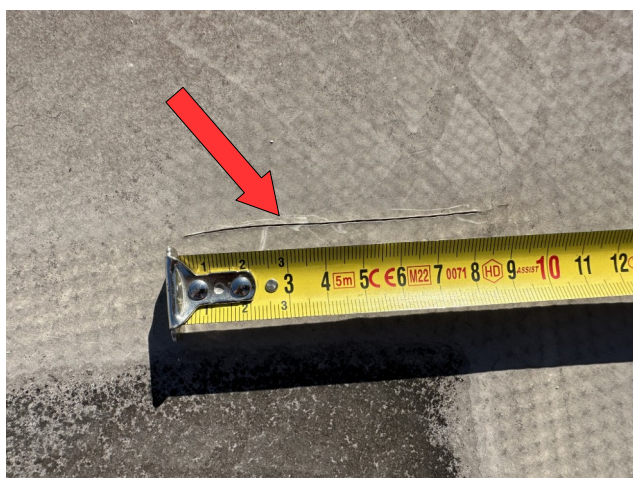
foto /145/ Pohled na jednu z perforací povlakové hydroizolace
